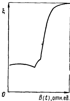
Рис. 2.20. Получаемая в эксперименте зависимость коэффициента прохождения \zeta от магнитной индукции:
